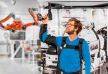
Softrobotisches Exoskelett, das den Menschen bei der Überkopf-Montage, wie sie z. B. noch häufig im Automobilbau zu finden ist, entlastet © Fraunhofer Institut
